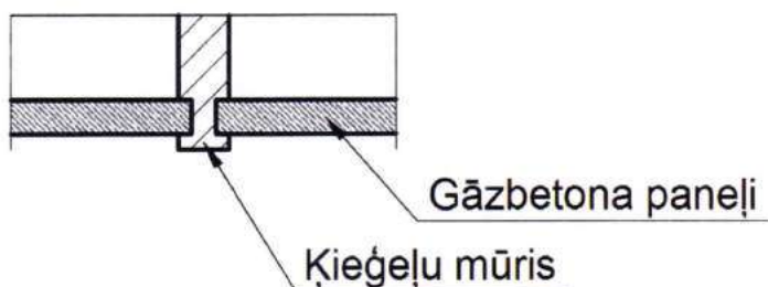
Att. nr.25. Nesošo ķieģeļu sienu un gāzbetona paneļu salaidums
